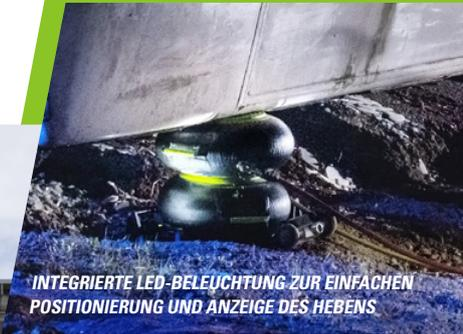
INTEGRIERTE LED-BELEUCHTUNG ZUR EINFACHEN POSITIONIERUNG UND ANZEIGE DES HEBENS
