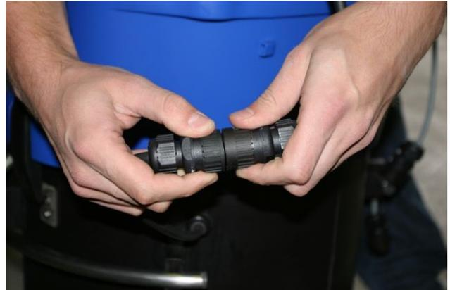
2. Öffnen Sie den elastischen Verbinder, indem Sie die zwei Schellen aufschrauben.
