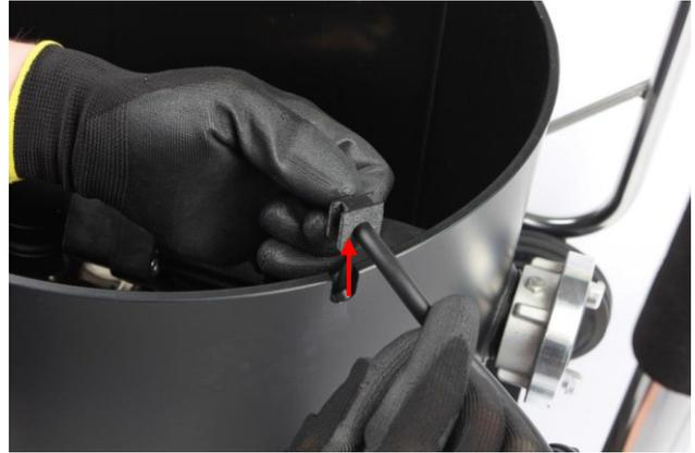
4. Heben Sie die Pumpe aus dem Behälter und achten darauf, dass der elastische Verbinder auf der pumpenseitigen Druckleitung verbleibt und nicht beschädigt wird.
